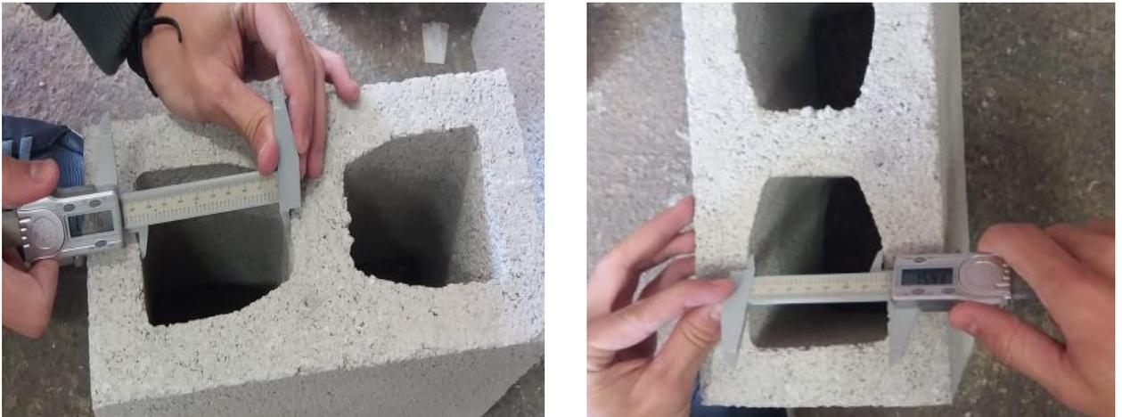
**Figura - 10:** Métodos de ensaio (DIMENSÕES DOS FUROS).
