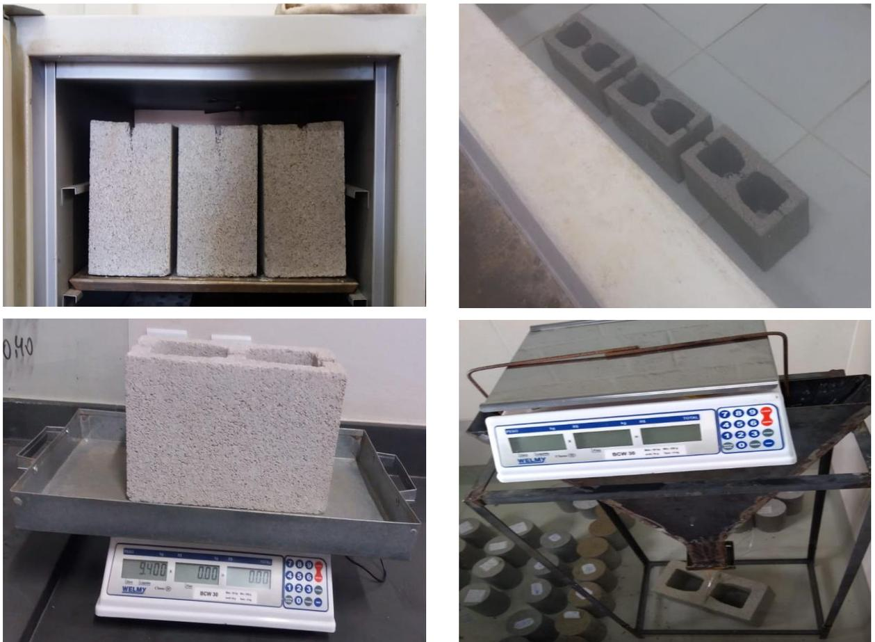
**Figura - 11:** Métodos de ensaio (MASSA SECA, SATURADA E APARENTE).
