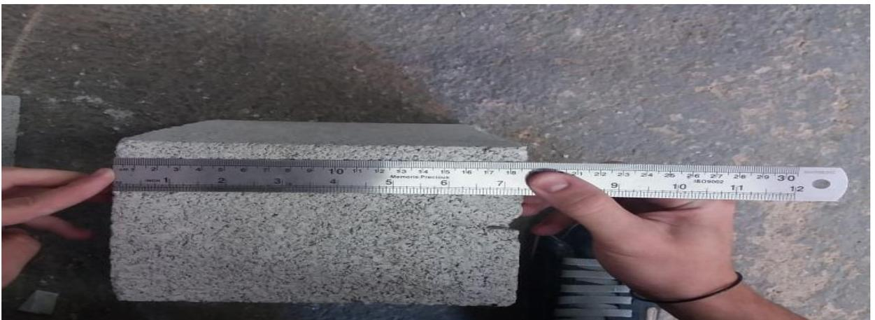
**Figura - 8:** Métodos de ensaio (COMPRIMENTO, LARGURA E ALTURA).
