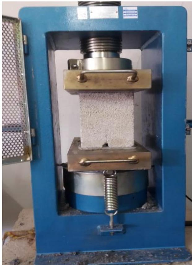
**Figura – 16:** Métodos de ensaio (RESISTENCIA A COMPRESSÃO).
