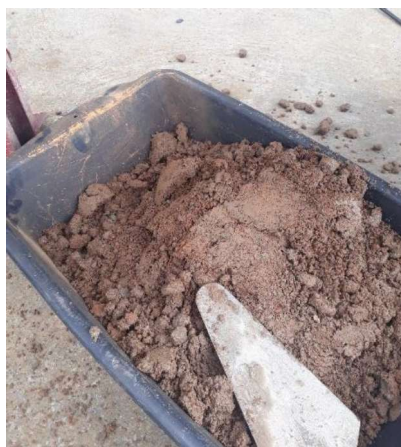
Figura 5. Característica concreto com 40% de adição de RCV
