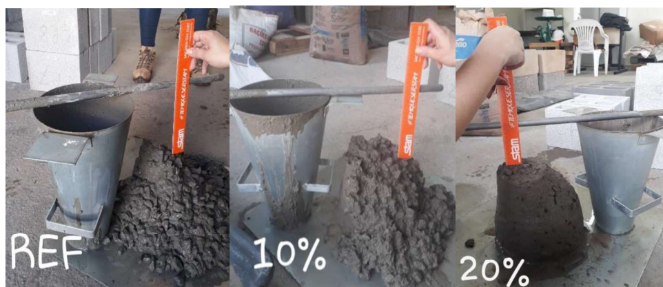
Figura 4. Determinação da consistência pelo abatimento do tronco de cone (Slump Test).
