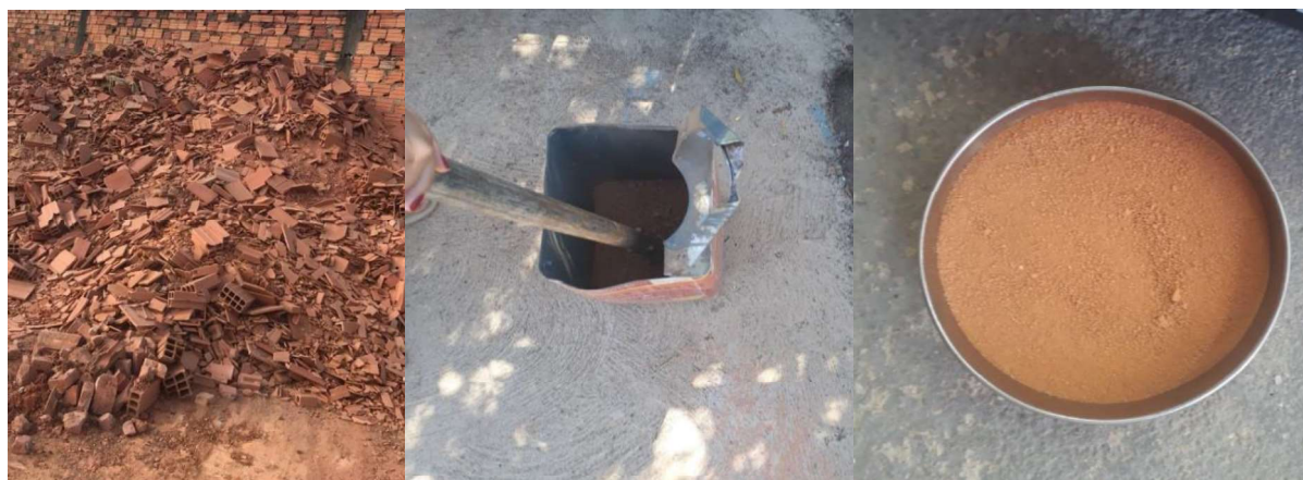
Figura 1 – Local de coleta, trituração manual do resíduo e aspectos após trituração.
