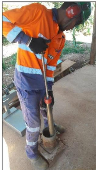
**Figura 3 -** Compactação das camadas do material
