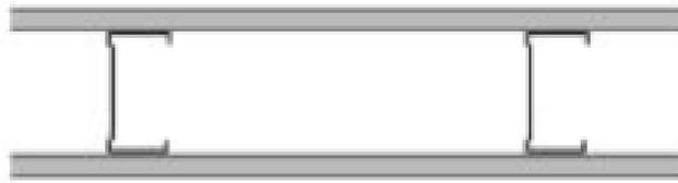
**Figura 3** – Esquema da parede simples
