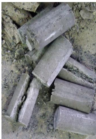
Figura 6 – Ensaio diametral do CRFA
