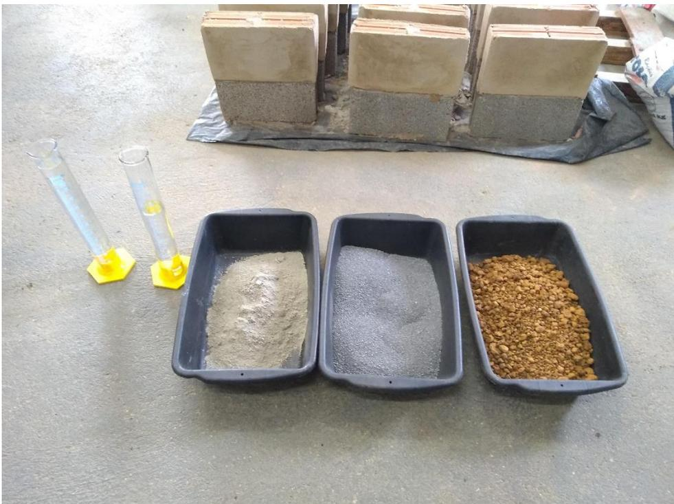
**Figura 23-** Proporções de dosagem- Concreto Laterítico.
