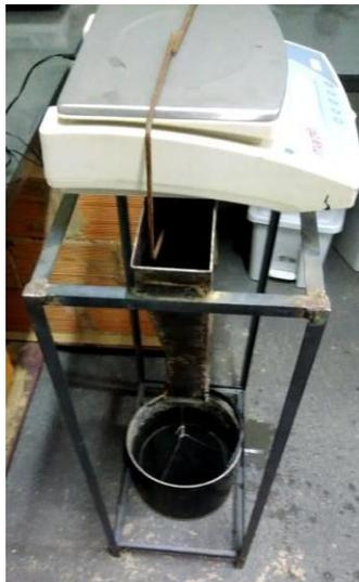
**Figura 11-** Massa específica do Agregado Graúdo
