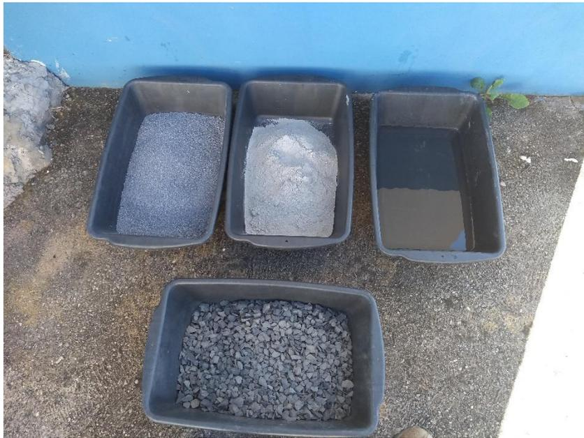
**Figura 20-** Proporção de dosagem do concreto convencional
