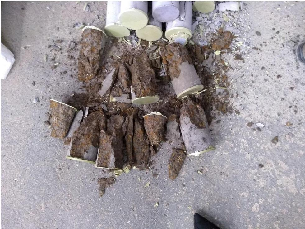
**Figura 22-**Rompimento- Corpo de prova Laterítico
