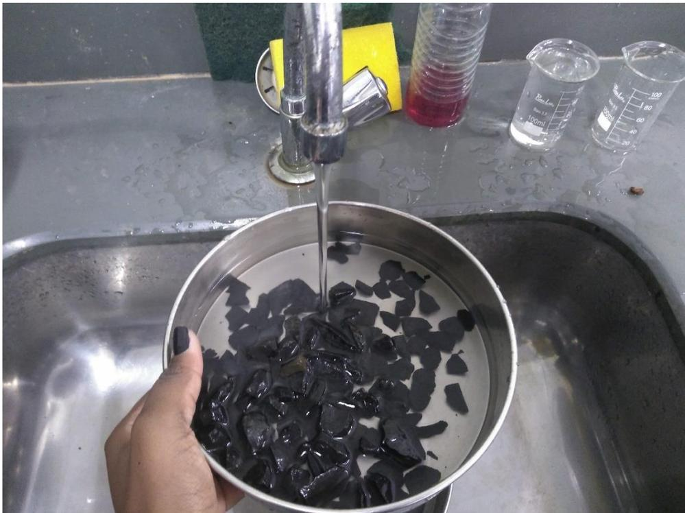
**Figura 15-** Lavagem do Agregado Graúdo para ensaio de material pulverulento
