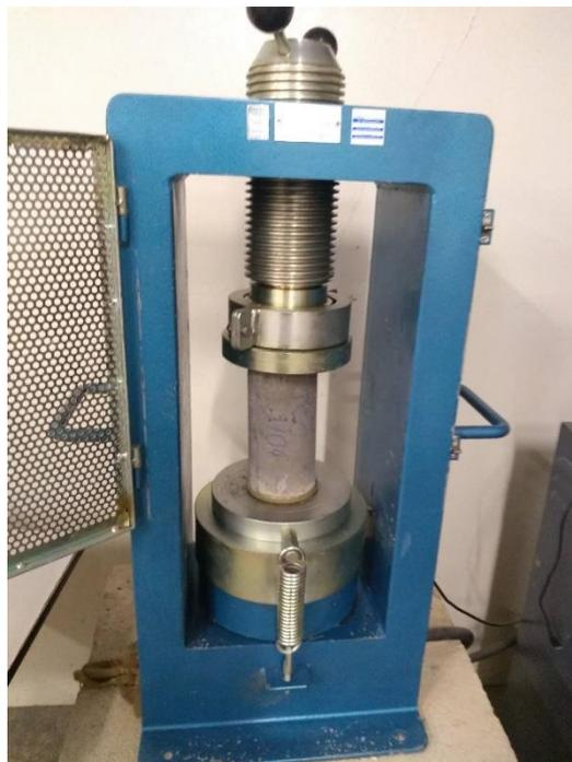
**Figura 25-** Rompimento do corpo de prova
