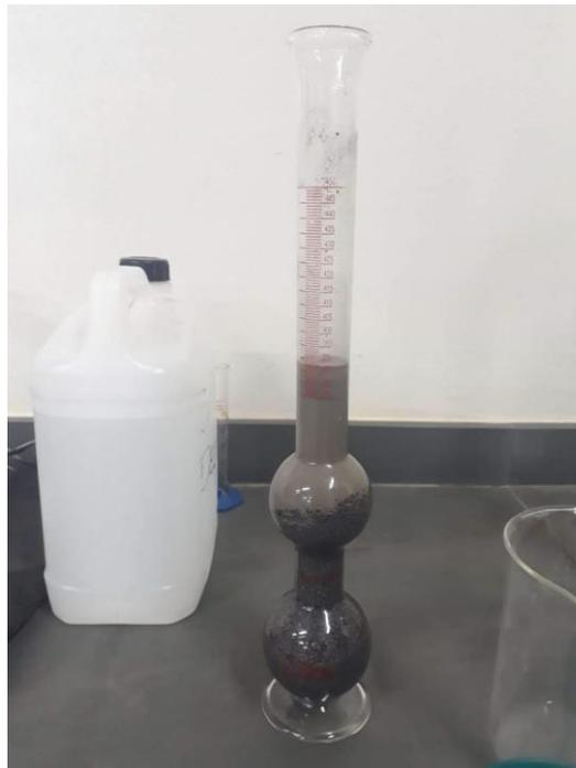
**Figura 17-** Massa Específica do Agregado miúdo
