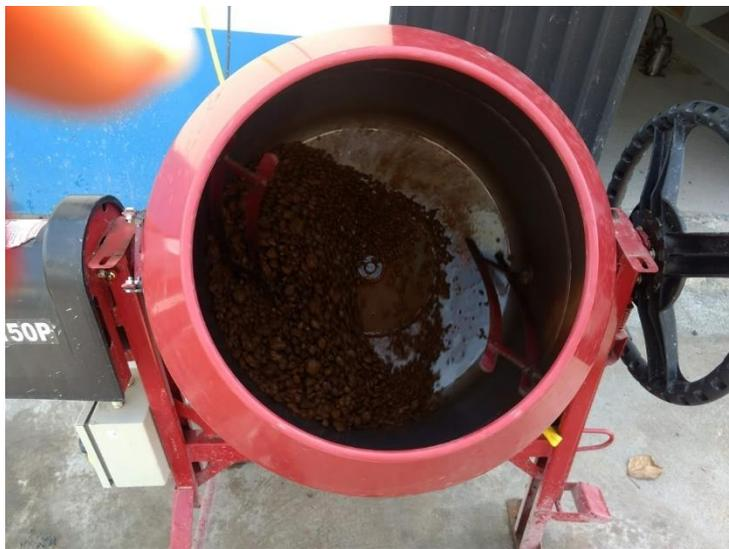
**Figura 19-** Confeção do concreto laterítico
