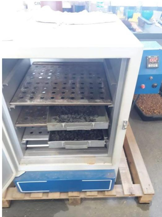
**Figura 16-** Secagem do agregado graúdo para ensaio de material pulverulento
