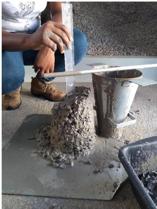
**Figura 21-** Slump test- Concreto Convencional
