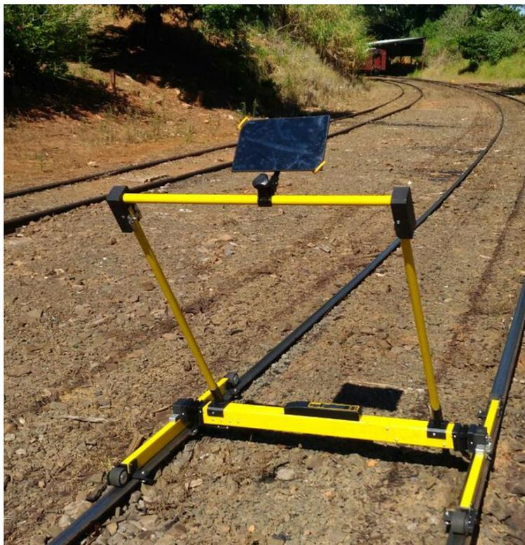
**Figura 22** – Trolley de geometria de via
