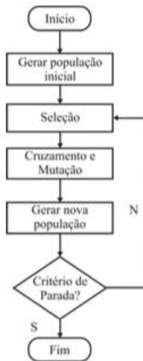
Figura 5: Estrutura do Algoritmo Genético
